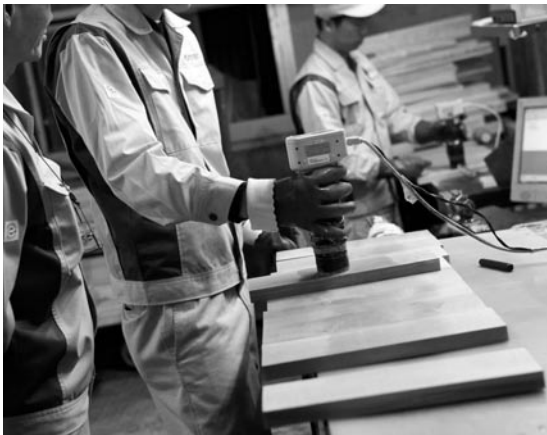
色差計を用い板子1本1本の色を測定する
