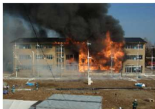
木造3階建て校舎の実大火災実験
