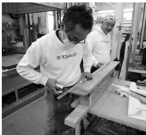
ガラス制作風景。ガラスの小口を手作業で研ぎ込んでいく。
